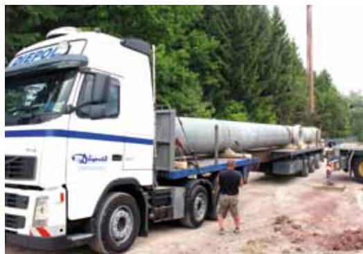
Mit einer Länge von 20 Metern und 1,10 Metern Durchmesser fasst dieser Hochleistungsenergiepfahl ein Wasservolumen von 19 Kubikmetern
