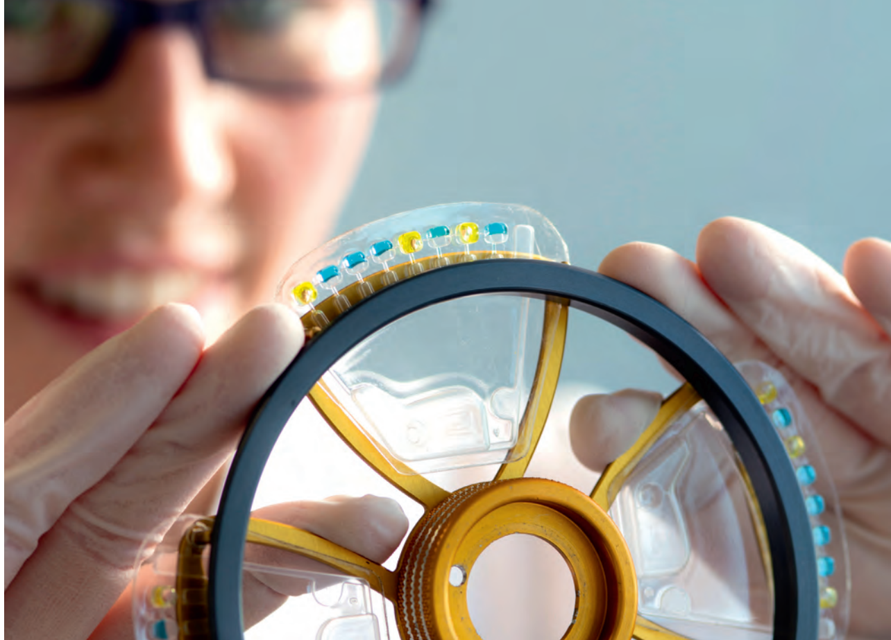
DIE LABDISK: Kunststoff-Kartuschen mit kleinen Kammern und Kanälen übernehmen die Aufgaben eines ganzen Großlabors
